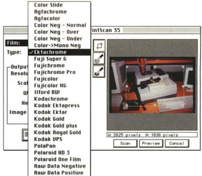
Dal pannello di comando possiamo settare vari parametri tra cui risoluzione, dimensione e rapporto di riduzione o ingrandimento. A destra le varie tarature per differenti tipi di pellicole.
