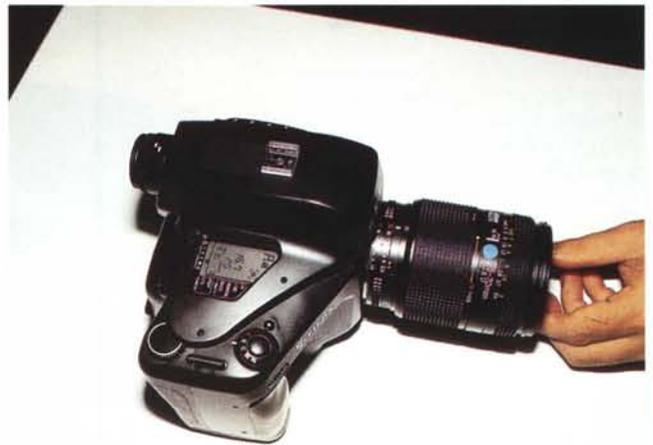
La Nikon E2 si impugna e si utilizza come una normale fotocamera reflex. Sul lato superiore, oltre ai comandi principali, troviamo anche un piccolo display LCD per il controllo delle funzioni.
